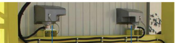
4 тензодатчика на каждой ёмкости обеспечивают точность процесса взвешивания и гибкость производства.
