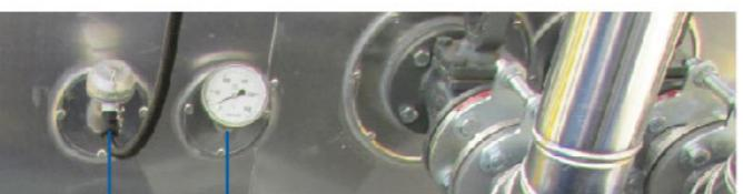
Аналоговый и цифровой терmostатические датчики на каждой ёмкости контролируют рабочую температуру в емкостях.
