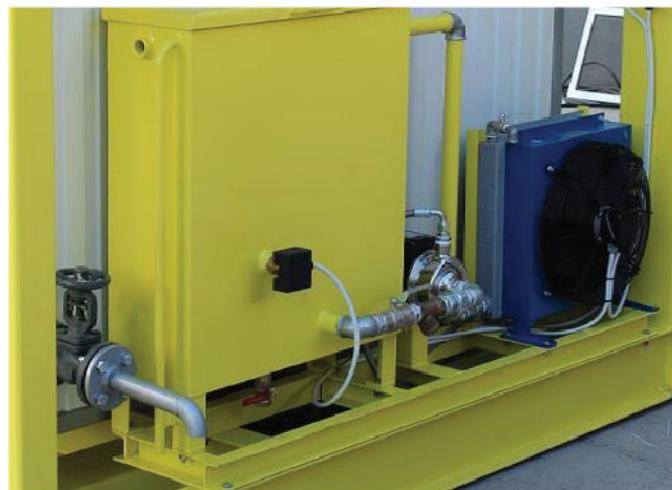
Система охлаждения мельницы продлевает срок эксплуатации уплотнителя и позволяет поддерживать высокий уровень производительности.
